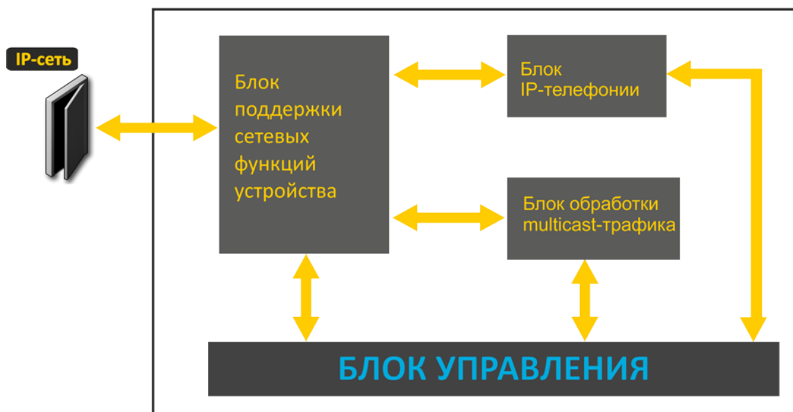
Рисунок 3 — Функциональная схема устройства серии TAU-4M.IP
